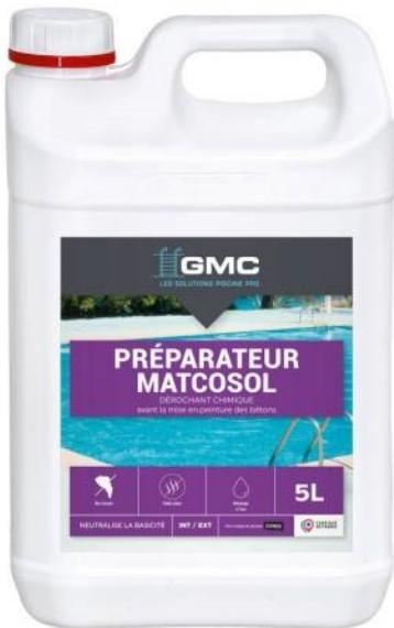
Dérochant chimique avant mise en peinture des bétons neufs ou à rénover. Il neutralise la basicité du support. Il crée la porosité indispensable à la bonne adhérence de la peinture. Il n'attaque pas les surfaces métalliques.
