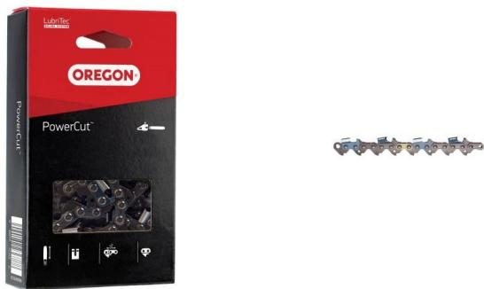
La chaîne de tronçonneuse Oregon PowerCut est une chaîne pour les bûcherons expérimentés et les ouvriers forestiers. Cette chaîne est dotée de lames Full Chisel de faible vibration qui coupent rapidement et précisément le bois. Les jauge de profondeur décalées rendent vos coupes plus lisses, car elles empêchent les cutters de s'enfoncer dans la paroi latérale de la coupe. La chaîne de tronçonneuse 20LPX064G est compatible avec Husqvarna® H23 64 et Stihl® 23RS3 64.
