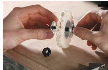
Arbre, filetage à gauche, avec deux rondelles de serrage et écrou de serrage, pour le serrage des meules en céramique, des disques de polissage en feutre, des disques de polissage, des brosses en sisal et des disques de polissage pour perceuses standard et sans fil.
