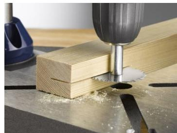
La scie à refendre, pour les rainures profondes et étroites, peut être utilisée à main levée ou stationnaire avec le support de perceuse kwb, pour le travail du bois.
