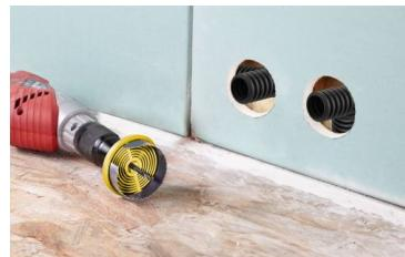
Scie cloche, 7 lames, arbre en aluminium moulé sous pression, dents en acier à ressort trempé, pour une utilisation dans le bois, les panneaux, les plaques de plâtre et les matériaux de construction légers. Ø de tige de 6mm. Diamètre : Ø 25 - 32 - 38 - 45 - 51 - 58 et 63 mm
