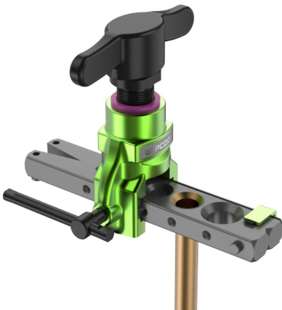
Outilage idéal pour les frigoristes et les climatiseurs. La dudgeonnière permet de réaliser des raccordements indispensables pour les liaisons frigorifiques présents dans un circuit de frigorifique. Les dudgeons sont réalisés sous la pression exercée sur l'extrémité du tube en cuivre, qui va s'évaser pour créer le dudgeon. Corps en alu. Butée de réglage. Livrée dans une mallette de transport.
