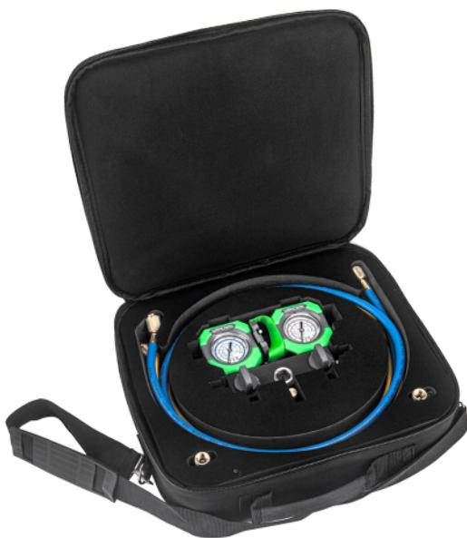
Outil de pointe conçu pour fournir des lectures précises et fiables. Jauge de précision de classe 1,6 rempli d'huile. R22, R410, R32. Ce manomètre est équipé de 3 flexibles silicone de 5/16" et 2 vannes de 1/4 tour en 1/4", ce qui en fait un outil polyvalent et efficace pour tout type de réparation. Led solaire et antichoc : protège l'écran du manomètre contre les chocs et les-rayons UV. Livré dans une mallette de rangement.
