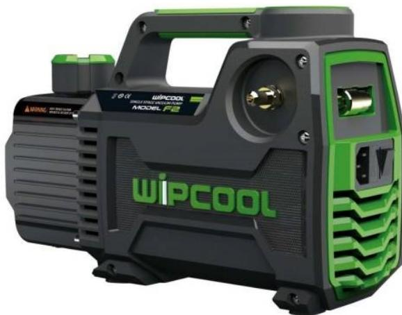
La technologie antidumping brevetée réduit le risque de fuite d'huile. Compteur de vide sur le dessus, design compact et facile d'utilisation. Électrovanne intégrée pour empêcher le refoulement. Conception anti-déflagration, convient pour le R32 et d'autres gaz réfrigérants. Pas d'injection d'huile et moins de déperdition d'huile, prolongeant la durée de vie du produit. Moteur nouvelle technologie, léger et facile à transporter. Bouchon de transport anti-fuite. Dimensions : 309x113x198mm
