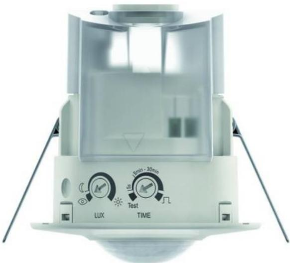
Détecteur de mouvement blanc 360° montage encastré plafond. Commutation au passage par zéro pour protection des contacts. Fonction de test pour contrôler la zone de détection. IP44. 1 canal. 230V 50Hz. Zone de détection : 50 m<sup>2</sup> (Ø 8 m | 360°).
