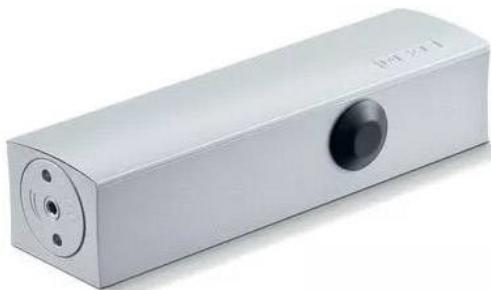
Ferme-porte en applique pour bras à compas pour les portes à un vantail jusqu'à une largeur de vantail de 110cm. Pour portes battantes droites et gauche et portes coupe feu. Force de fermeture à réglage variable EN 2-4. Vitesse de fermeture réglable par l'avant via une vanne. Avec à-coup final réglable, qui accélère la porte juste avant la position fermée.
