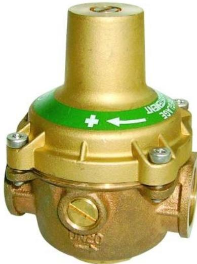
Réducteur de pression Desbordes Série 11 Bis F/F. Prise de pression 1/4 de chaque côté pour montage mano. Plage de réglage aval de 1 Bar à 5,5 Bar, livré pré réglé à 3 BAR. Pression maxi 25 bars, température maxi 80°C. Raccords femelles. Garantie constructeur 5 ans.
