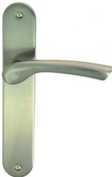
Béquille légèrement en spirale et cintrée, de forme conique en s'élargissant vers la fin. Incurvée au niveau de son embase, en aluminium finition nickel mat de saillie 54 mm se terminant en biseau. Montée directement sur la plaque acier traité dans la même finition de 7 mm d'épaisseur et de largeur 38 mm. Assemblée par un serre-clips qui rend solidaire la béquille sur la plaque qui est équipée d'un ressort de rappel.
