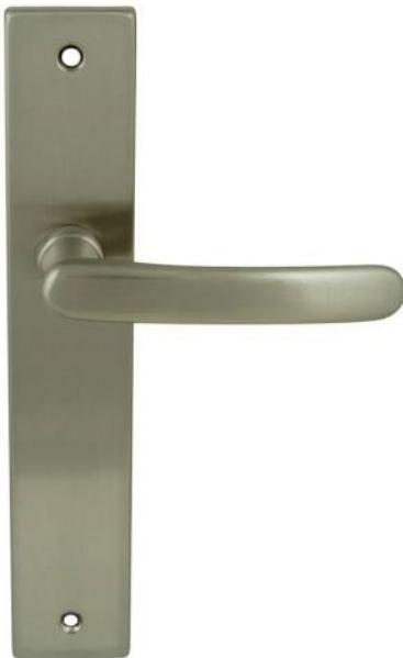
Béquille de face plate en arc de cintre, en aluminium finition nickel mat et de saillie 46mm se terminant en arrondi de chaque côté. Montée directement sur la plaque acier traité dans la même finition de 8 mm d'épaisseur et de largeur 41 mm. Assemblée par un serre-clips qui rend solidaire la béquille sur la plaque qui est équipée d'un ressort de rappel.
