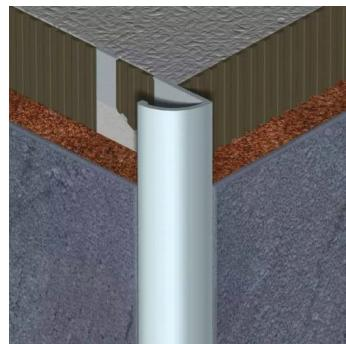
Quart de rond ouvert en aluminium. Profilé en aluminium pour la protection et la finition des surfaces carrelées. Protège les supports. Masque les coupes du revêtement. Pose encastrée : se fait en même temps que la pose du carrelage.
