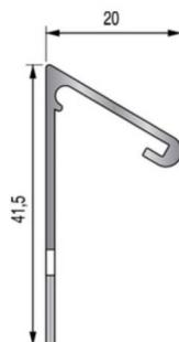
Profilé en aluminium anodisé, à visser en pose rapportée, qui permet d'évacuer le ruissellement des eaux de pluie en façade et en nez de balcons. Prévient la dégradation des bords de balcons et terrasses carrelés. Pour l'extérieur.
