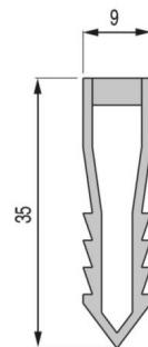
Profilés rigides et compressibles en PVC bi-dureté, à encastrer dans les joints de fractionnement des chapes, des dalles ou des ouvrages carrelés. Peuvent servir de règle lors de la mise en œuvre d'une chape ou d'un carrelage. A encastrer. Trafic tertiaire. Pour l'intérieur, l'extérieur et maxi pack.
