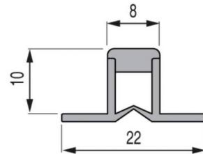
Profilés rigides et compressibles en PVC bi-dureté avec semelle de 22mm. Le profilé est à coller au niveau des joints de fractionnement des ouvrages carrelés. Peuvent servir de règle lors de la mise en œuvre du carrelage. Trafic tertiaire. Pour l'intérieure et maxi pack.
