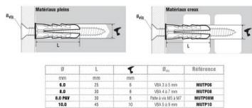
En polypropylène très rigide et incassable. Très bonne tenue dans tous types de murs. Crantage antirotation Ouverture ultra rapide lors de l'expansion. Convient à tous les types de matériaux (béton, maçonnerie pleine et creuse, plâtre et parpaing creux) et fonctionne avec vis, patte à vis, clou...
