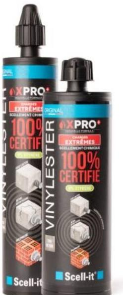
Pour charges lourdes et très lourdes. 3 ETA pour toutes les applications dans le béton (Option 1, Maçonneries et Fers). Idéal pour le scellement de tige filetée M8 à M24 dans le béton, le scellement de tige filetée M8 à M16 dans les maçonneries pleines et creuses, le scellement de barres d'armatures de renfort Ø8 à 32mm, le reprise de fer à béton Ø8 à Ø25mm et les applications sismiques C1 (M8 à M16) et C2 (M12 à M16).
