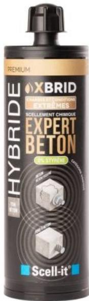
Résine hybride vinylester-uréthane sans styrène. Idéal pour le scellement de tige filetée M8 à M30 acier électrozingué et inox A4-70, le scellement de barres d'armatures de renfort Ø8 à 32mm et la reprise de fer à béton Ø8 à Ø32mm. ATE Option 1 et ATE Fers. Application possible en trous immersés et jusque +160°C.
