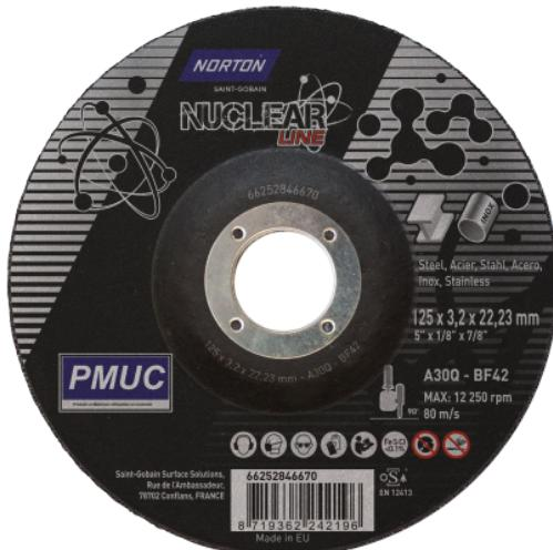
Disque développé pour répondre à la norme PMUC (nucléaire). La concentration de chlorures+bromures+fluorures et la concentration en souffre est inférieure à 200ppm. Utilisable pour toute activité réalisée au contact direct de matériaux métalliques des circuit EIPS ou/et des fluides transportés par ces circuits (cf : EDF PMUC V4).
