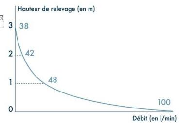
Idéal pour douche et receveur extra plat. Livrée avec 1 bonde extra-plate et 1 clapet anti-retour. Température admissible 35°C. Déclenchement bas 30mm.
