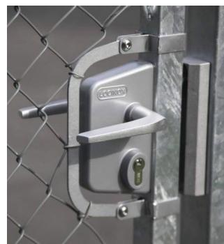
Serrure type industrielle pour portail battant avec coffre en aluminium thermolaqué et mécanisme en acier inoxydable. Le réglage des pênes de 20 mm en continu permet un alignement parfait de votre mécanisme de fermeture. Un ancrage de 23 mm du pêne dormant en acier inoxydable massif assure un verrouillage sécurisé. Le modèle standard est fourni avec une paire de poignées en aluminium.
