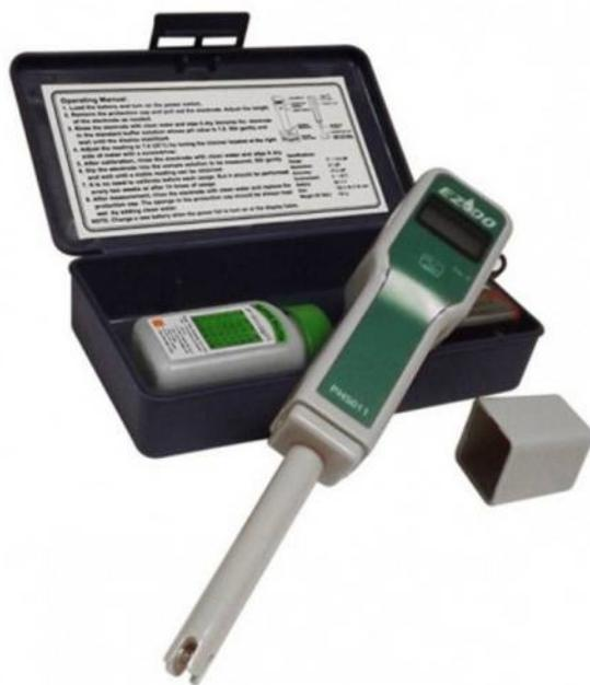
Permet de mesurer le taux de pH présent dans l'eau. Compact et facile à utiliser, il suffit de le plonger dans l'eau et de lire la mesure sur son affichage digital. Sonde de mesure télescopique. Il vous assure une mesure fiable avec une précision à +/- 0,1 pH. Il est conseillé d'avoir un taux de pH entre 7,0 et 7,6 pour des baignades de qualités et sans risques. Au-delà de ces mesures, la désinfection utilisé pour l'eau sera également moins efficace.
