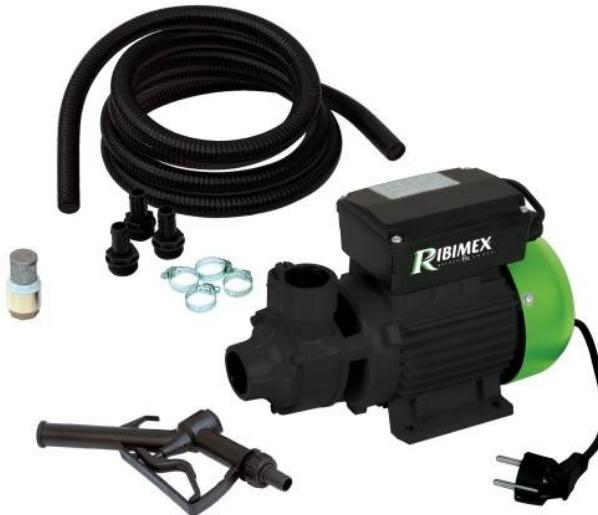
Electropompe périphérique utilisable pour le pompage du gasoil et de l'eau propre. Corps de pompe et support moteur en fonte, turbine en laiton, arbre moteur en acier inox. Moteur électrique monophasé avec condensateur incorporé. Indice de protection IP55.
