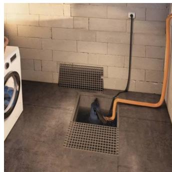
Pompe submersible pour eaux claires permettant pompage des eaux d'inondation de pièces de vie ou de caves. Cette pompe pour inondation se déclenche automatiquement grâce à son bras de déclenchement intégré. Submersible, elle peut être immergée jusqu'à 7 m de profondeur et relève les eaux jusqu'à 11 m avec une granulométrie de 20 mm. Livrée avec câble d'alimentation de 10 m, coude de raccordement à 90° avec clapet anti-retour, bague de blocage du flotteur. IP68. Garantie 2 ans.
