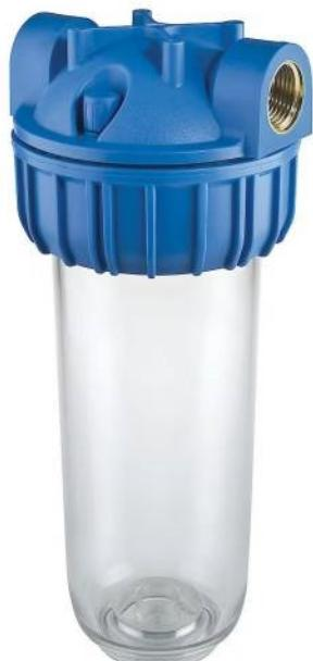
Filtre 3 pièces avec inserts en laiton. Grâce au large choix de cartouches disponibles sur ce modèle, il peut être utilisé pour filtrer les impuretés sur une arrivée générale ou en protection d'un appareil et pour traiter ponctuellement contre le tartre ou les mauvais goûts et odeurs. Pression en service 8 bars. Température : 30/40° C maximum. Équerre et clé incluses.
