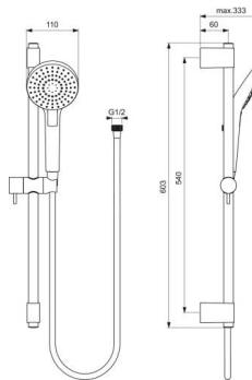
Ensemble barre 60 cm et douchette EVO Ø110mm 3 jets : jet pluie, effet revigorant, massage, 8 l/min, flexible anti-torsion 1,75m chromé - Easy-grip, Changement de mode à l'aide du bouton Navigo. Anticalcaire. Picots en silicone.
