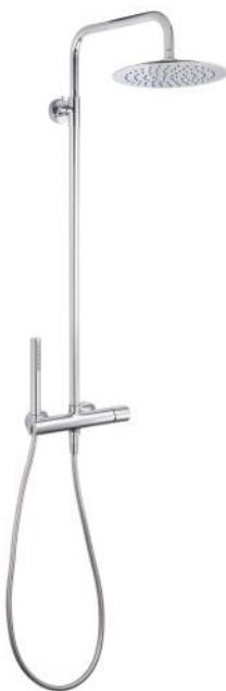
Mitigeur mécanique, inverseur intégré sortie douchette, support de douchette intégré au mitigeur, entraxe 150 mm réglable de 130 à 170 mm, filtres et 2 rosaces chromées. Pomme de tête ø 250mm, orientable, ABS et picots anto-calcaires. Douchette forme stylo 1 fonction 185x25mm, ABS et picots anto-calcaires. Flexible PVC lisse 150cm, structure anti-torsion. Colonne inox Ø22/24mm. Hauteur 846 à 1263mm. Saillie 338mm.
