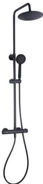
Mitigeur thermostatique, inverseur intégré côté débit, bouton sécurité anti brûlure à 38°C, entraxe 150 mm réglable de 130 à 170 mm grâce aux raccords excentrés +/- 20mm, 2 rosaces noires, filtres et clapets anti-retour incorporés. Pomme de tête Ø 220mm, orientable, ABS et picots auto-calcaires. Douchette 3 fonctions Ø 100mm, ABS, picots auto-calcaires, support coulissant et inclinable. Flexible PVC lisse 150cm, structure anti-torsion. Colonne métal Ø20/24mm. Hauteur 800 à 1100mm. Saillie 330mm.
