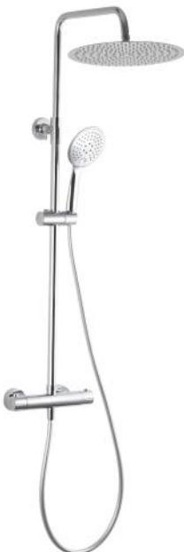
Mitigeur thermostatique, inverseur intégré côté débit, bouton sécurité anti brûlure à 38°C, entraxe 150 mm réglable de 130 à 170 mm, 2 rosaces, filtres et clapets anti-retour incorporés. Pomme de tête inox Ø 300mm, orientable et picots anto-calcaires. Douchette 3 fonctions Ø 125mm, ABS, picots anto-calcaires, support coulissant et inclinable. Flexible PVC lisse 150cm, structure anti-torsion. Colonne inox Ø20/24mm. Hauteur 800 à 1120mm. Saillie 340mm.
