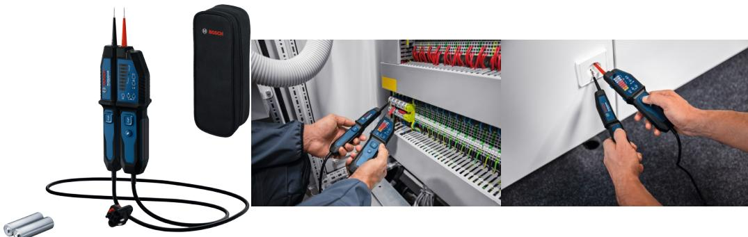
Testeur de tension robuste pour une sécurité et une efficacité accrues. Conçu pour les chantiers exigeants avec indice de protection IP65, connexion parfaite entre le câble et l'outil et résistance aux chocs. Test de tension jusqu'à 1 000 V CA/CC avec alertes visuelles, sonores et vibratoires. Livré avec 2 piles AA et étui.
