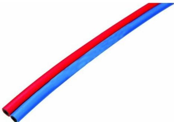
Tuyaux jumelé en caoutchouc pour l'utilisation d'oxygène/acétylène en soudage coupe et techniques connexes. N'est pas adapté au GPL, MPS et gaz naturel. Intérieur : Caoutchouc synthétique résistant aux gaz de soudage. Renforcement: Textile synthétique avec de bonnes propriétés élastiques. Extérieur : Caoutchouc synthétique bleu/rouge résistant aux abrasions et aux fluctuations climatique.
