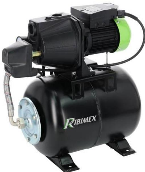
Surpresseur équipé d'une pompe de la gamme jet cuve en tôle peinte époxy. Câble électrique de 1,40m. Pression de déclenchement marche/arrêt au pressostat. Cuve 24L. Hauteur d'aspiration 7 m. 35m de longueur maxi d'aspiration. 1,4 à 2,5 bars de pression. Entrée / Sortie : 1" / 1".
