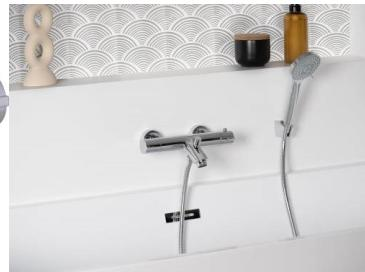
Corps en laiton. Montage mural, entraxe 150 mm. Cartouche thermostatique. Tête céramique 1/2 tour. Sortie douche M15x21 (1/2"). Aérateur mousseur M28x100 anti-calcaire. Réglage de la température avec bouton de sécurité anti brûlure à 38°C. Inverseur automatique. Raccords excentrés et rosaces fournis. Deux filtres et clapets anti retour incorporés. Garantie 5 ans.
