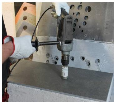
Cette adaptateur M14-HEXA13 permet de monter les trépans diamant MLS (emmanchement meuleuse M14) sur une perceuse (emmanchement HEXA13).
