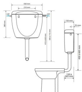
Réservoir semi-bas à commande simple volume latérale par manette, garantie 10 ans. Réservoir réglé à 6L, aspect céramique de capacité maximale 9L, équipé d'un mécanisme simple volume et d'un robinet flotteur silencieux, connexion en eau externe 3/8" à droite ou gauche. Livré avec un coude d'alimentation, des accessoires de fixation et de connexion.
