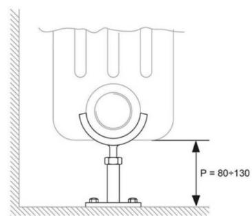
L'utilisation du pied support au sol doit être combiné avec les chelas au premier et au dernier élément dans la partie haute du radiateur.
