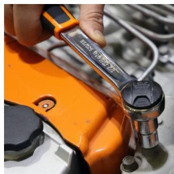
Entraînement carré phosphaté. Mécanisme à 72 dents. Angle d'enroulement: 5°. Taille minimale de la tête. Inversion d'une seule main. Appuyer sur la tête avec la main ne provoque pas d'inversion et permet toujours un retour à levier libre. Poignée ergonomique bi-matière, avec trou de suspension pratique. Excellentes caractéristiques mécaniques.
