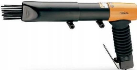
Conseillé pour éliminer la rouille, la peinture et les résidus de soudure sur les surfaces métalliques. Les aiguilles en acier ont un mouvement indépendant, ce qui permet l'accès à tous types de fissures. C'est un outil utile pour enlever les résidus. Équipé de 19 aiguilles ( $\varnothing$  3 mm).
