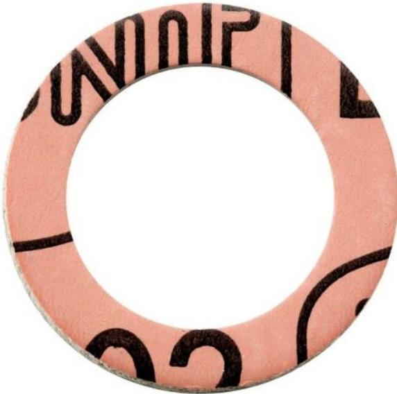
Idéal pour air, eau et huile. 2 et 3 mm d'épaisseur. Température maxi / continue / vapeur/ mini : 180 / 120 / - / -150°C. Pression : 40 bar. Composition : 4x 3/8" - 4x 1/2" - 4x 3/4" - 2x 1" et 2x 1"1/4
