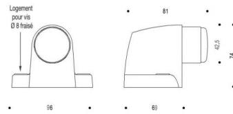
Corps en zamak. Bouchon amortisseur en élastomère noir absorbant les chocs. Livrée sans fixation. Cale de rehausse disponible en option.
