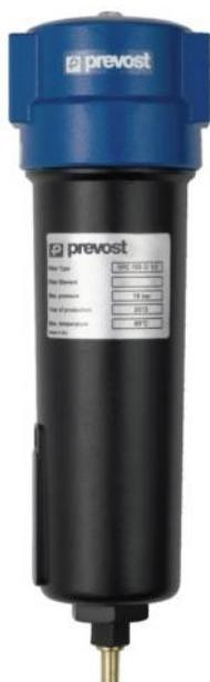
Idéal à la sortie d'un compresseur ou d'une cuve. Double action : séparation et évacuation. Construction robuste. Fonctionnement économique et fiable. En aluminium anodisé. 16 bar pression maxi d'utilisation. Température de 1 à 65°C. Équipé d'une purge automatique à flotteur.
