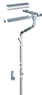
Le dauphin coudé en fonte Rheinzink est un élément du système d'évacuation des eaux pluviales. Installé en partie basse de la descente, sa fabrication en fonte lui confère une excellente résistance aux chocs. Esthétique et robuste, il s'intègre harmonieusement à l'architecture du bâtiment.
