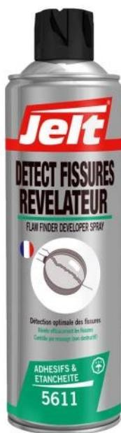
Permet le contrôle par ressage. Révélateur blanc poudreux. Solution économique facile à mettre en œuvre sur un chantier. Insensible à l'orientation des défauts par rapport à la surface. Déetecte de petits défauts susceptibles de générer des fuites. Déetecte parfaitement la porosité des métaux. Utilisable sur des matériaux pour lesquels le contrôle magnétoscopique est inefficace. Utilisable sur des pièces lorsque la désaimantation est critique ou pour des pièces complexes.
