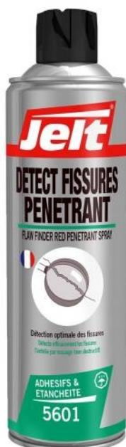
Permet le contrôle par ressage. Pénétrant rouge. Solution économique facile à mettre en œuvre sur un chantier. Insensible à l'orientation des défauts par rapport à la surface. Détecte de petits défauts susceptibles de générer des fuites. Niveau de sensibilité 2, suivant la norme ISO 3452-2. Utilisable sur des matériaux non ferromagnétiques. Utilisable sur pièces ferromagnétiques sans désaimantation.
