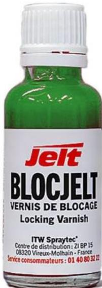
Vernis opaque qui forme un film isolant pour le blocage de vis. Permet de rendre les systèmes vis / écrous inviolables. Maintient les fils et bloque les assemblages et montages. Offre un contrôle de garantie et préserve les interventions de SAV. Bloque les vis soumises aux vibrations sur tous les supports. Séchage rapide en 10 min. Utilisable de -40°C à +135°C.
