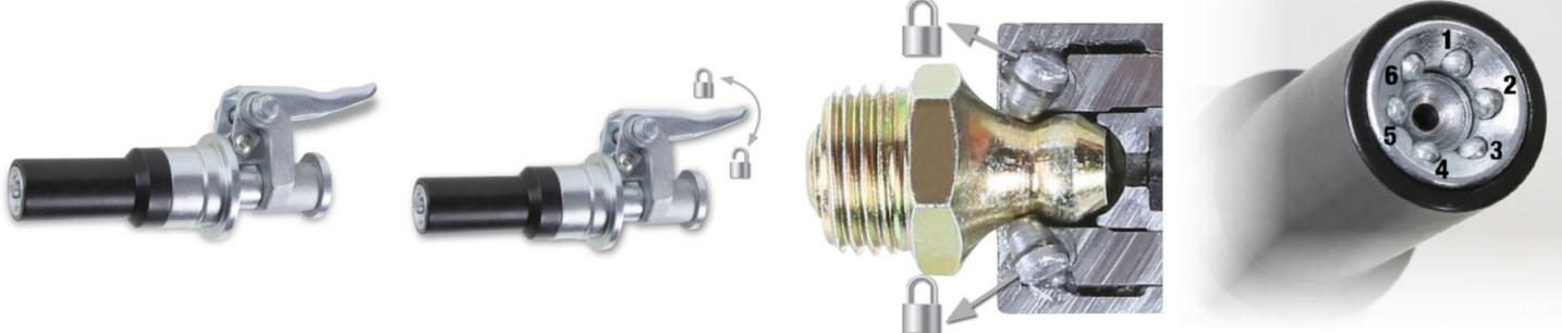
Une fois positionnée, elle reste sur le graisseur sans aucune aide. Déconnexion facile même avec tête sous pression. Filet M10x1 adapté à tous les types de pompe à graisse : électrique, pneumatique, manuelle...
