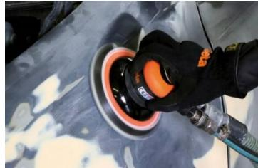
Sans lubrification. Aucune lubrification requise. Très compacte et maniable. Diamètre orbite 5 mm. Plateau avec bande auto-grippante 6 trous. Réglage en continu de la vitesse du moteur. Poignée en matériau antiglisse souple. Prévue pour le branchement à des systèmes d'aspiration avec raccord pivotant. Échappement de l'air orientable.
