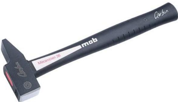
Utilisé au départ par les mécaniciens, qui recherchent à la fois de la puissance et de la précision. Tête en acier à forte teneur en carbone C45E. Tête forgée, avec traitement thermique par induction des surfaces travaillantes (54 HRC). Chanfrein de 1/20e de la tête à 45°. Manche composite Carbon quadri-matière, avec une âme incassable en fibre de verre et 2 barreaux de fibre de carbone, du polypropylène anti-vibration et une surinjection en élastomère pour le grip.
